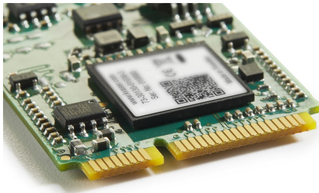
Figure 2: Mini PCI Express connector
